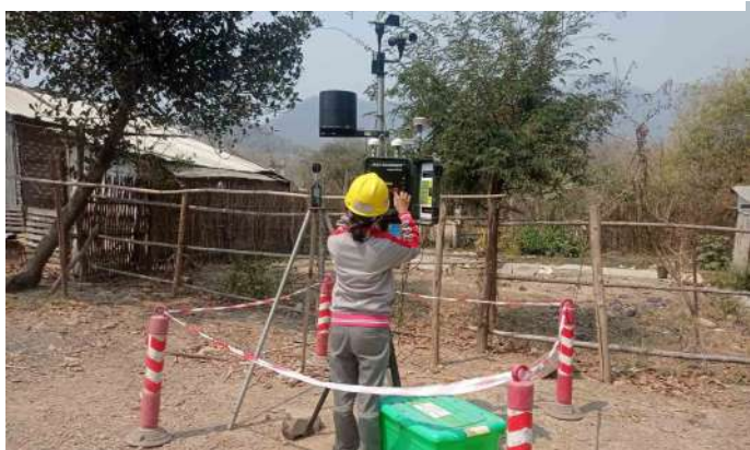
ပုံ - ရွှေတောင်ဘိလပ်မြေကုမ္ပဏီဝန်းအတွင်းရှိ ယာယီ ဝန်ထမ်းအိမ်ရာများအနီးတွင် လေထုအရည်အသွေး တိုင်းတာ စစ်ဆေးခြင်း။
